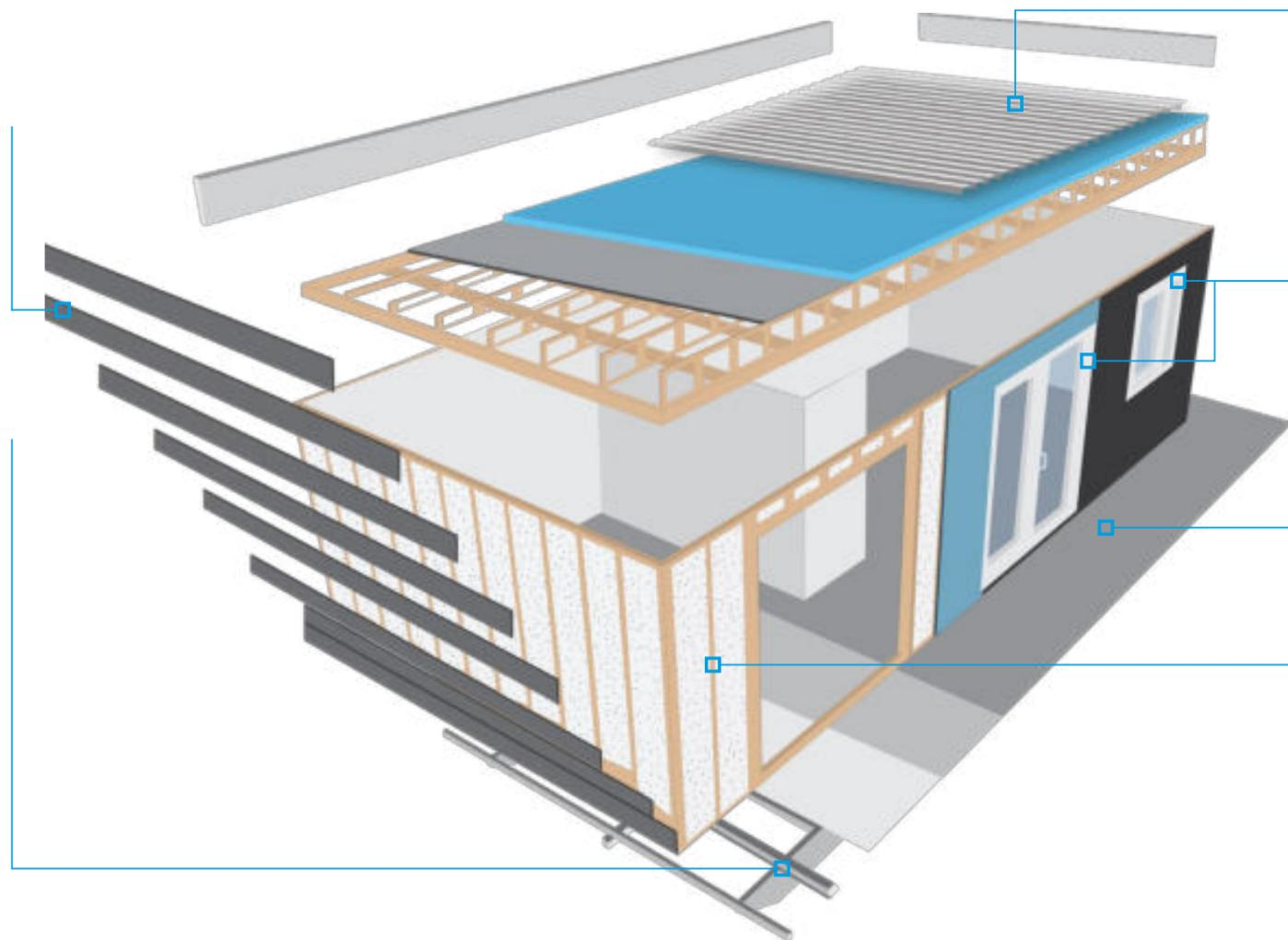
Tetto (monofalda oppure doppia falda): struttura in legno d'abete, isolamento tramite strato di lana minerale (sp. mm. 50), sormontata da barriera al vapore in polipropilene anticondensa, copertura con lamiera grecata preverniciata (colore a scelta) o pannelli metallici. Grondaia esterna o nascosta. Portata tetto 150 kg/mq (il doppio rispetto a quanto previsto dalla norma UNI EN 1647, classe B). Particolari coibentazioni termiche e maggiorazione per portata neve su richiesta.
